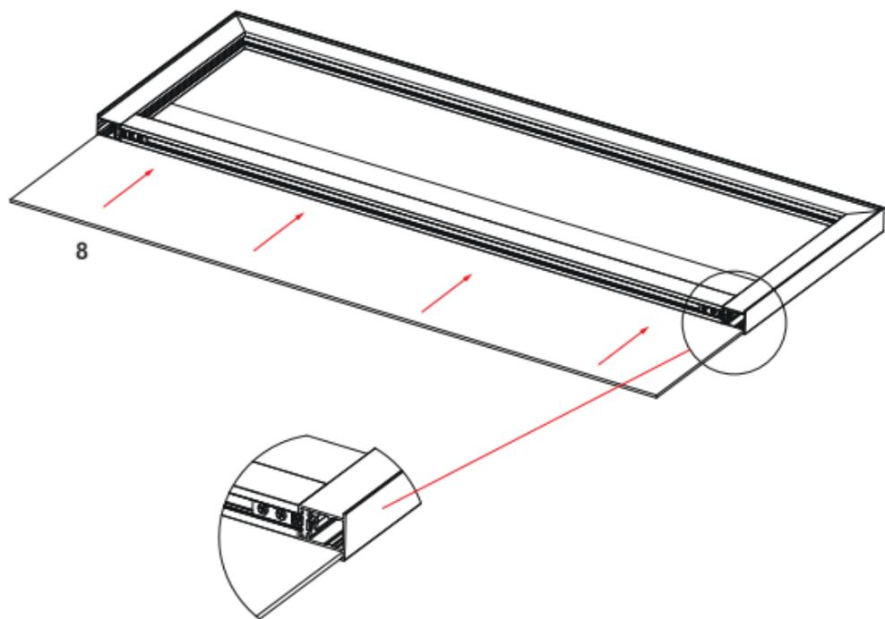
COM O AUXILIO DO ESTILETE, CORTE OS POSICIONADORES DO CONECTOR 95P
