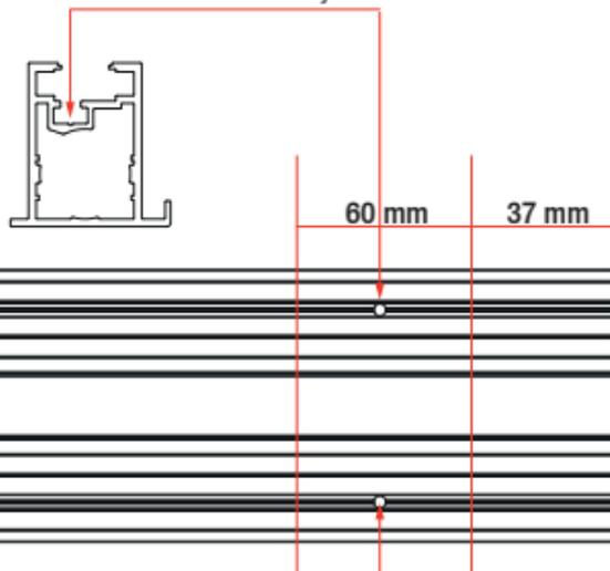
REALIZE A FURAÇÃO PASSANTE Ø4MM APÓS A COTA DE 37MM,
