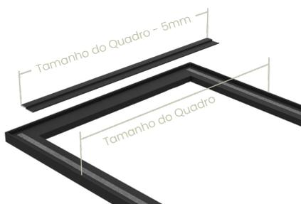
03. Encaixar o perfil na extremidade. Respeitar o desconto de 5mm para realizar o encaixe dos perfis.
