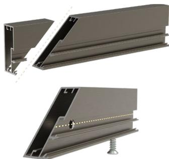
Ao utilizar grampos para fixação da tela, é necessário cortar o Baguete 15 e aplicá-lo pela lateral do perfil, descontando a região do encaixe do parafuso.
