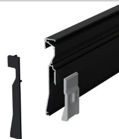
03. Após são aplicadas as ponteiras de acabamento dos perfis, através de encaixe lateral. Para cálculo de corte, devem ser descontados os 2mm da sua espessura.
