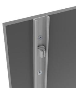
03. Aplicar o conector próximo da medida desejada. Utilizar o gabarito de distanciamento para posicioná-los. Após, rotacionar no outro sentido, travando-o. Posteriormente, pressionar o perfil ripado sobre o conector para fixá-lo.
