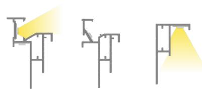
Montar a moldura externa com o perfil 9581 ou 9582 em corte de 45°. Junte os perfis, utilizando a cantoneira 20.
