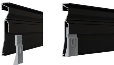
01. Prenda o suporte na parede para que seja possível fixar o rodapé, após encaixe e pressione o suporte de cima para baixo. Encaixe seguro e firme através dos serrilhados.
